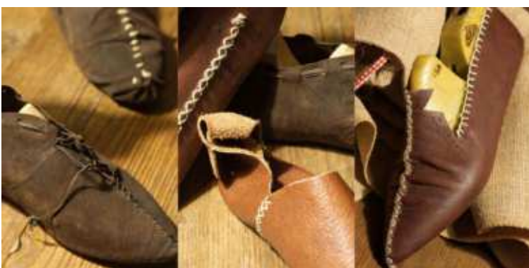
Rys. 3 Detale konstrukcyjne, techniki łączenia elementów cholewek, różne warianty szycia ozdobnego, przykładowe rodzaje skór.
